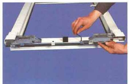
2.5. Разметить по шаблону отверстия для верхнего рулевого механизма (см. фото).
