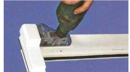
2.3. Установите вспомогательный элемент крышки нижнего механизма (поз.11) примерно по середине между кронштейнами (поз.7а и 7б) (см. рис. 3).
